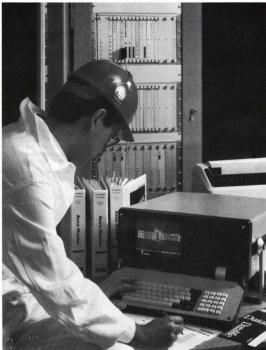
Afb. 1. Programmeren met de ASEA Master-Piece-Taal op het programmeerapparaat MasterAid 214.
