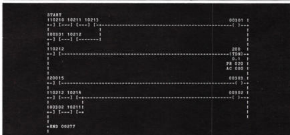
Afb. 2. Ladderdiagram op een beeldscherm.
