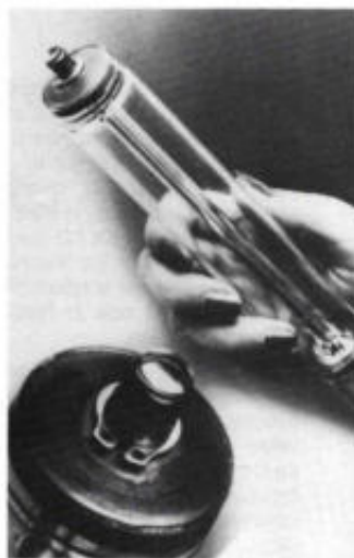
Groenstralende coaxiale He-Ne-laser (golflengte 543 nm, vermogen 0,5 W, werkspanning 2,4 kV, lengte 400 mm; diameter 45 mm).
