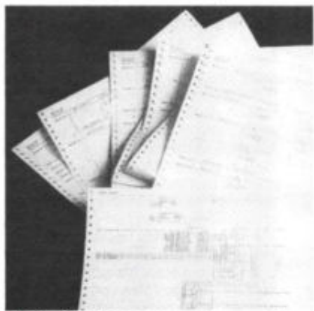
Afb. 3. Grafische programmadocumentatie; het enkele vel op de voorgrond is een voorbeeld van de MasterPiece-taal en bevat hetzelfde programma als de overige vellen in ladderdiagram-voorstelling.
